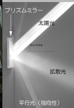
プリズム2次ミラー プリズム2次ミラー：大成建設株、日本特殊光学樹脂共同開発。特許出願中
